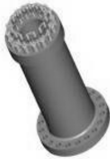
Fig. 8. Modelo 3D de um eixo superior, flangeado
